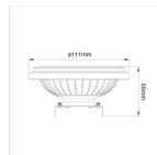
Scheda tecnica Noxion Lucent Faretti LED G53 AR111 7.4W 450lm 40D - 930 Luce Calda | Miglior resa cromatica - Dimmerabile - Sostitutiva 50W
