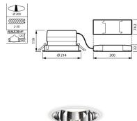
Scheda tecnica Philips Downlight LED LuxSpace Compatto Profondo DN571B 20.9W 2600lm 75D - 840 Bianco Freddo | 214mm - Aluminium Riflettore
