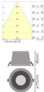
**Scheda tecnica Ledvance Downlight LED Biolux DN150 21W 2200lm 60D - 927-965 Regolabile Bianca | 175mm - Ritaglio 160mm - Dali Dimmerabile - Miglior Resa Cromatica**
