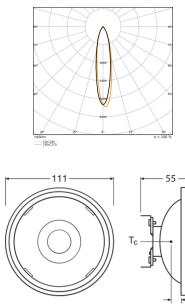
Scheda tecnica Ledvance Parathom Pro LEDspot G53 AR111 7.4W 450lm 24D - 930 Luce Calda | Miglior resa cromatica - Dimmerabile - Sostituiva 50W
