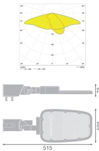
Scheda tecnica Ledvance Proiettore LED Area Medio Grigio 65W 8450lm 160x58D - 730 Luce Calda | IP66 - Simmetrico
