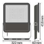
Scheda tecnica Ledvance Proiettore LED Area Nero 105W 13750lm 48x92D - 830 Luce Calda | IP65 - Asimmetrico
