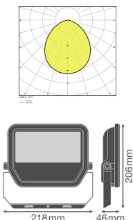
**Scheda tecnica Ledvance Proiettore LED GEN 3 Nero 50W 5500lm 100D - 830 Luce Calda | IP65 - Simmetrico - Sostitutiva 100W**
