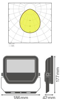
**Scheda tecnica Ledvance Proiettore LED GEN 3 Bianca 30W 3600lm 100D - 865 Luce del Giorno | IP65 - Simmetrico**
