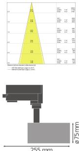
**Scheda tecnica Ledvance Luce a Binario LED D75 Bianca 25W 1750lm 24D - 930 Luce Calda | Miglior resa cromatica**
